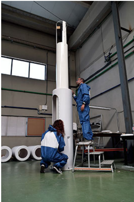
El mástil oscila para generar energía.
