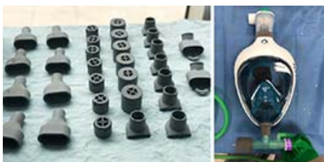
Imagen de los prototipos que permiten adaptar las máscaras de buceo de Decathlon.
