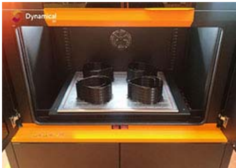
La Impresora DT60 fabrica 84 pantallas por impresión.
