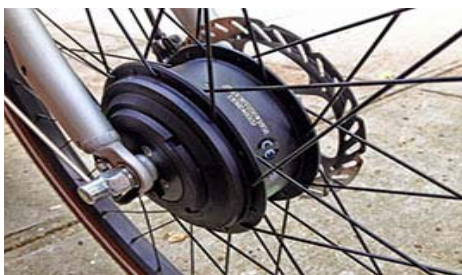
Vista en detalle del motor de eje en la rueda delantera.
