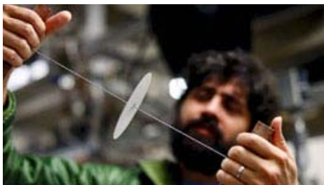
Manu Prakash demuestra el funcionamiento de la centrífugadora de sangre manual, Paperfuge.
