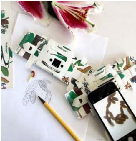
El Foldscope funciona sin electricidad, pesa 10 gramos y magnifica hasta 2000 veces.
