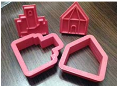
Moldes impresos en 3D con tecnología FDM.
