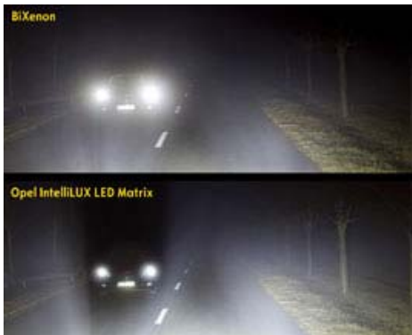
Comparación entre faros de Xenon y la nueva tecnología.
