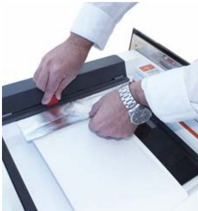
Sistema de corte del aluminio.
