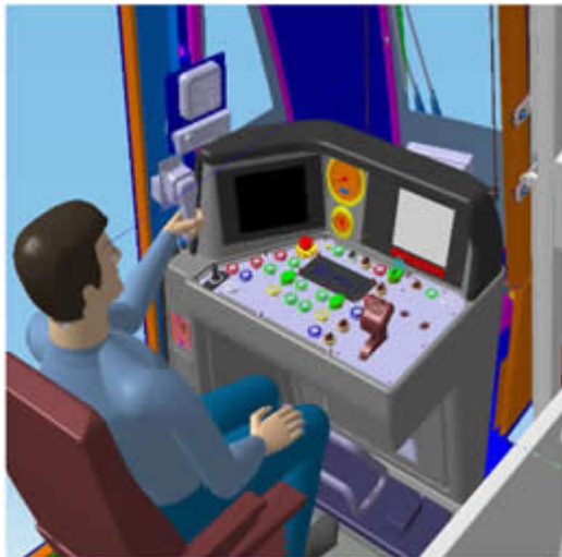
Alcances para el 95 percentil masculino en un puesto de conducción de Metro de Delhi.
